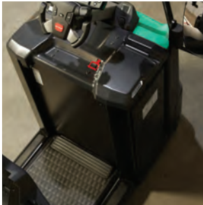
Schwebend aufgehängter Fahrerstand.
