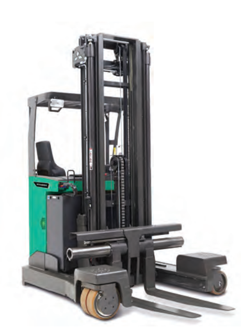
RBM20-25N3 Baureihe 4-wege-stapler 2000 – 2500 kg
