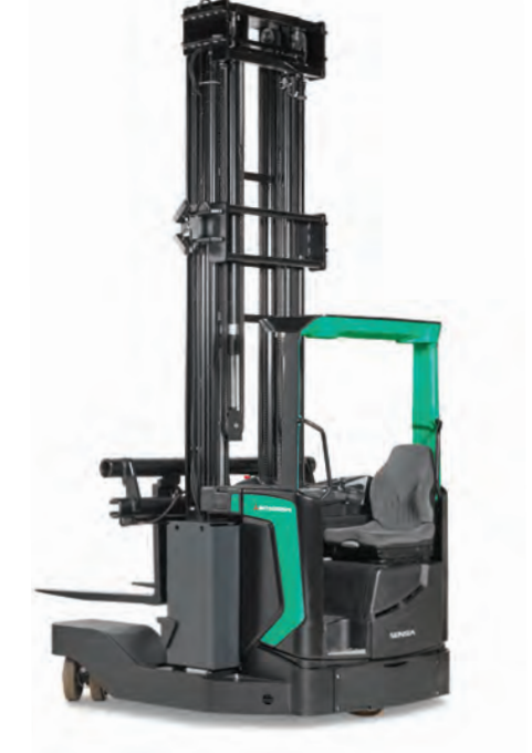
RBM20-25N3 Baureihe 4-wege-stapler 2000 – 2500 kg
