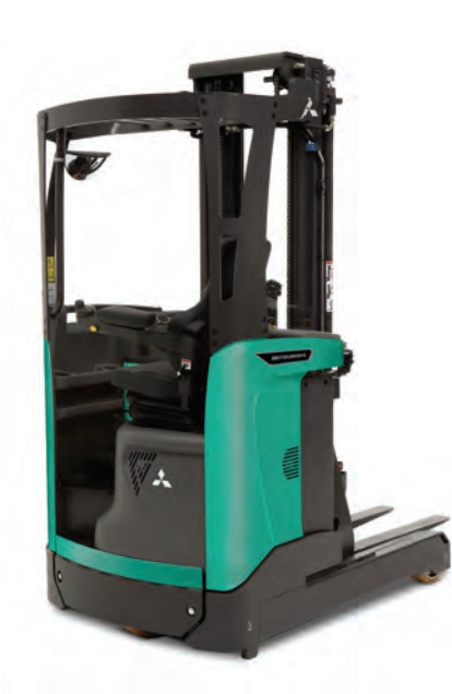
RB12-14N3(L)(C) Baureihe Schubmaststapler Light 1200 – 1400 kg
