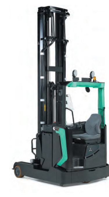
RB16-25N3H(X) Baureihe Schubmaststapler 1600 – 2500 kg
