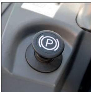
Ideal – Betätigen der automatischen Handbremse per Knopf
