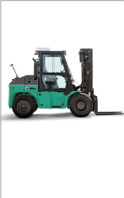
**Der 3,8-Liter Vierzylinder-Common-Rail-Turbodieselmotors mit vier Zylindern der die Euro-Emissionsvorschriften der Stufe V vollständig erfüllt, erreicht eine Fahrgeschwindigkeit von 27 km/h. 81 kW (110 PS) Leistung sorgen für hohe Produktivität bei geringer Geräuschkentwicklung und niedrigem Kraftstoffverbrauch.**
